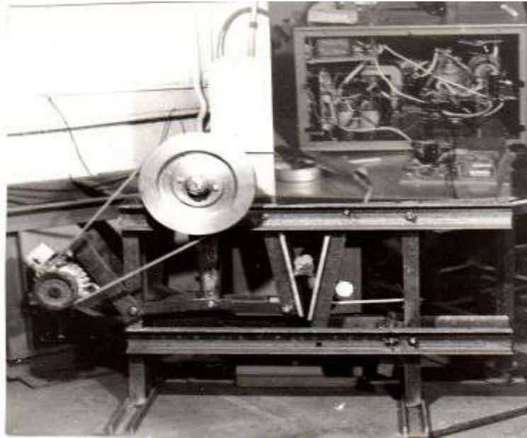
Рис. 3. Лабораторна шоківій дробарка з розташованим на ній генератором УВЧ
